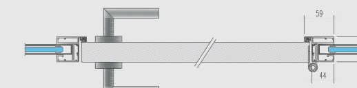
horizontální řez dveřním modulem
